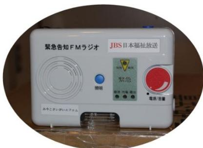
インタッチが被災地で配布した防災ラジオ。電源がオフの時でも緊急放送を自動受信し、最大音量で知らせてくれる。
